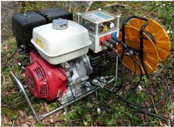
Figure 2 : groupe EFKO FEG 8000 et exemple de pêche à 1 anode sur un cours d'eau DE 5 à 6 de mètres de largeur
