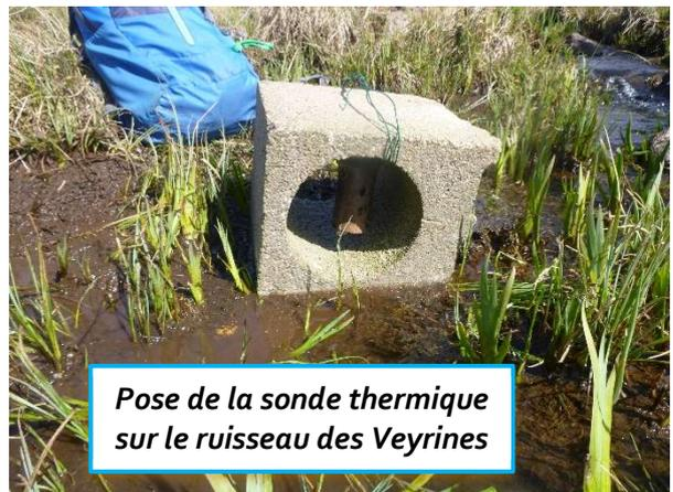
*Pose de la sonde thermique sur le ruisseau des Veyrines*
